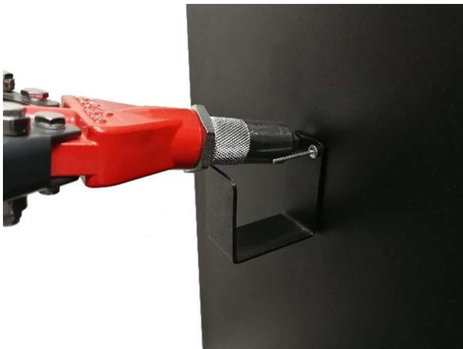
Figura 27. Método de fijación de los ganchos mediante remaches
