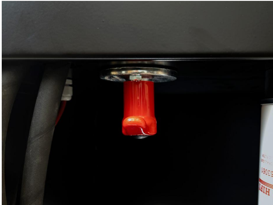
Figura 3. Interruptor en posición de encendido
