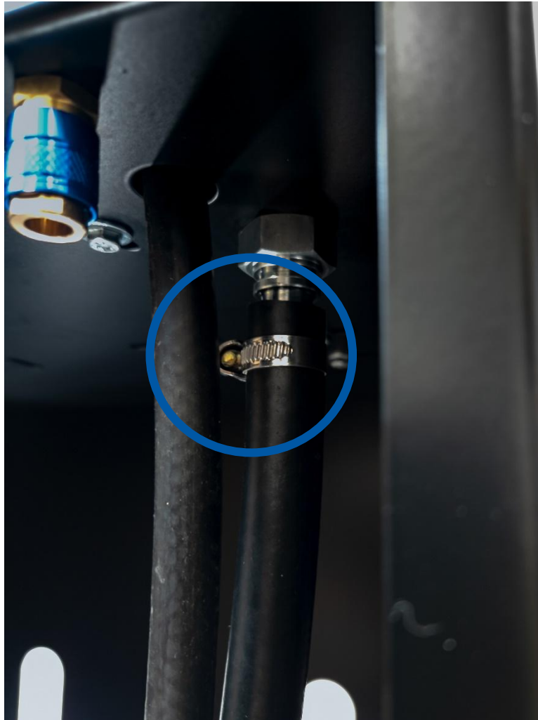
Figura 25. Abrazadera para ajustar la longitud de la manguera de aspiración
