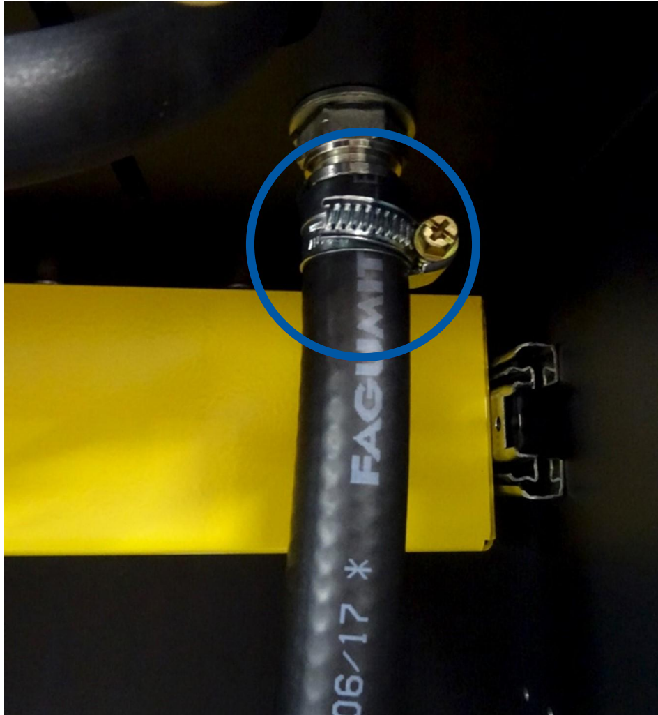
Figura 25. Abrazadera para ajustar la longitud de la manguera de aspiración
