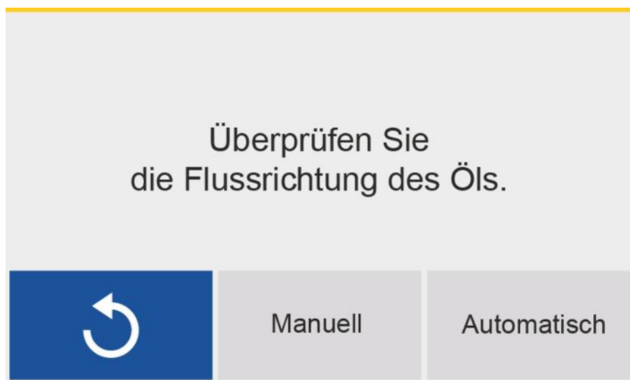
Abbildung 16. Information über die Notwendigkeit, die ATF-Ölflussrichtung zu überprüfen
