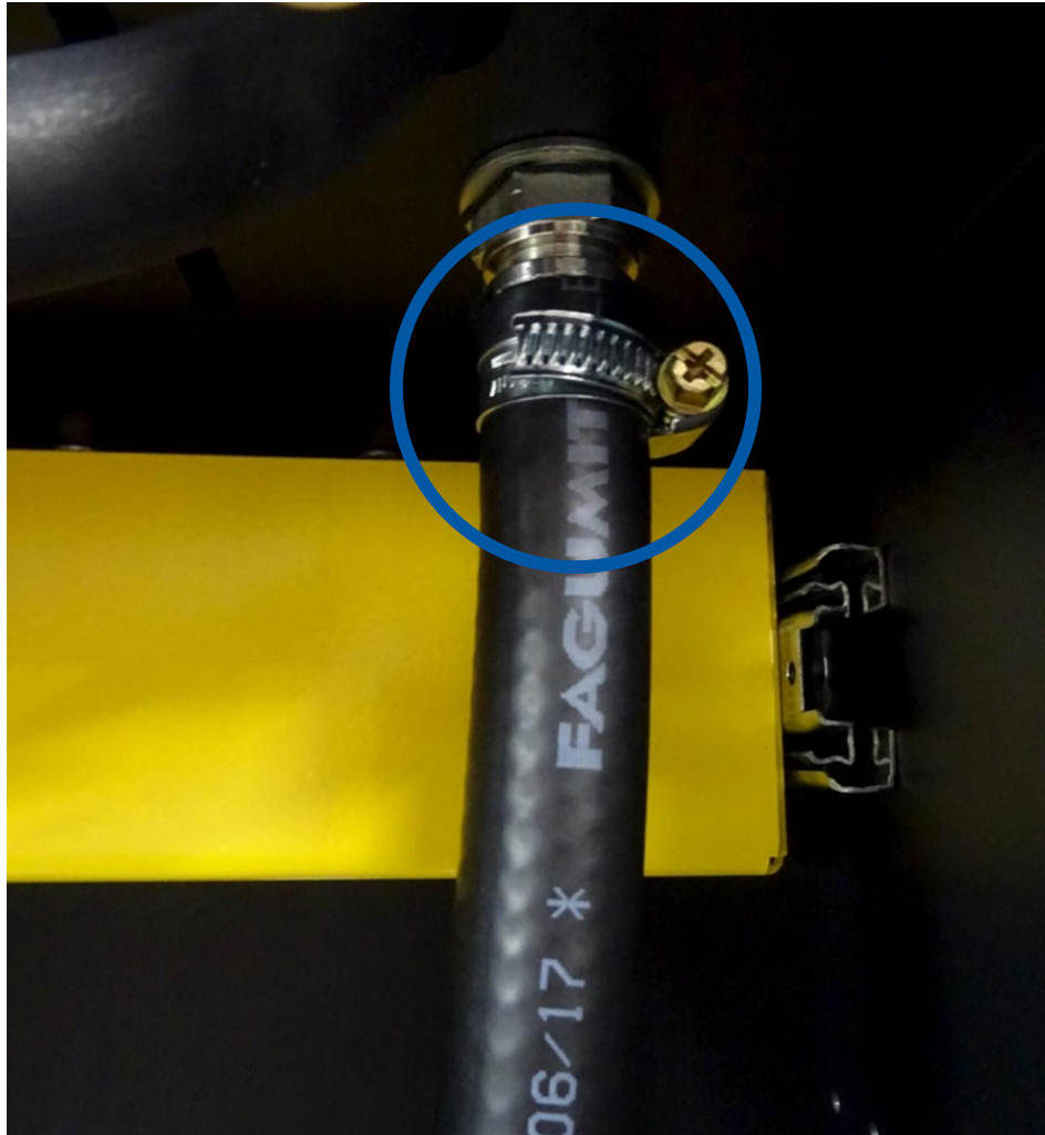
Abbildung 25. Schelle zur Einstellung der Länge des Ansaugschlauches
