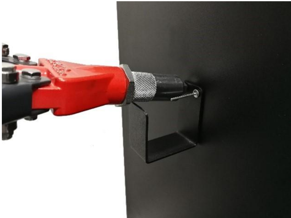
Abbildung 27. Vorgehensweise beim Annieten der Haken
