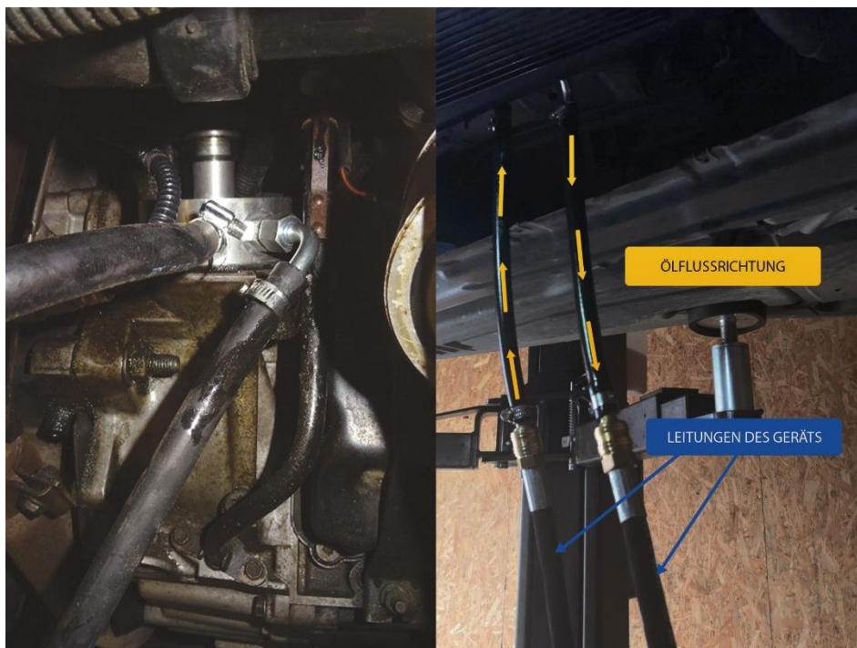
Abbildung 6. Anschluss der Adapter vom Gerät an das Getriebe Rechts: Anschluss an die Ölleitung des Getriebekühlsystems. Links: In diesem Fall wurde beim AW55-50-Getriebe der runde Wärmetauscher durch einen speziellen Adapter (einschließlich Dichtung und Distanzstücken) ersetzt.
